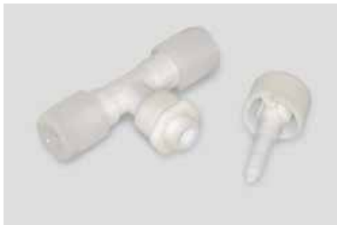
Bild links: Modell eines Ventiles, hergestellt durch Lasersintern
